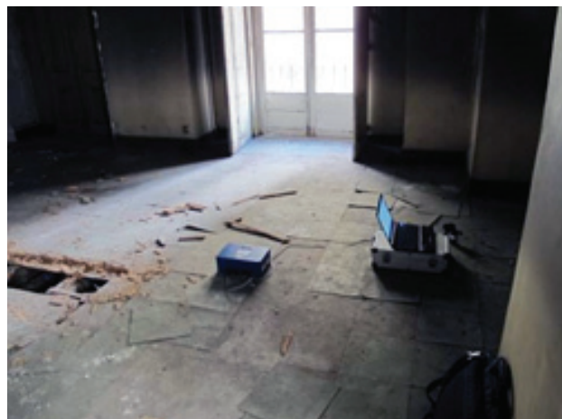
Figura 4 Utilização de sismógrafo na identificação dinâmica de um pavimento de madeira na Baixa pombalina
