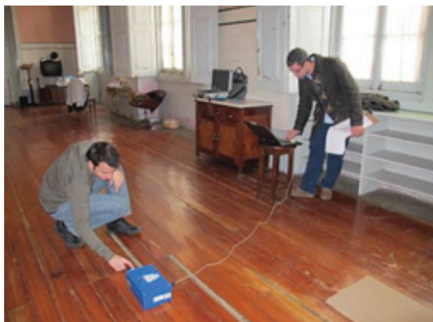
Figura 3 Utilização de sismógrafo na identificação dinâmica de um pavimento de madeira no centro do Porto
