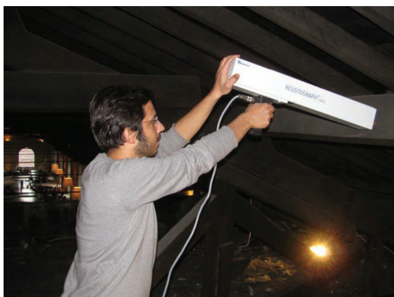
Figura 3. Ensaio com resistógrafo
