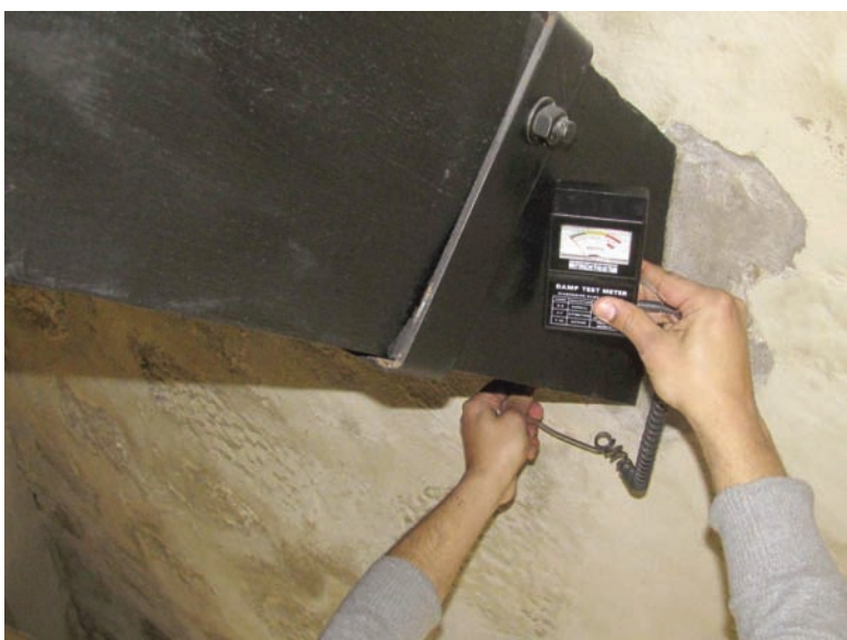
Figura 2. Ensaio com higrómetro
