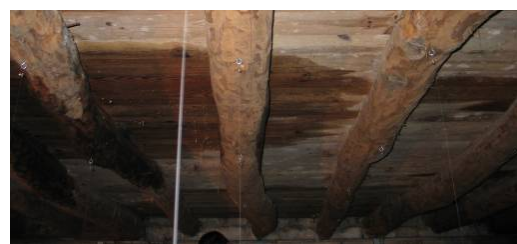
Fig. 7 – Ensaio 2, pavimento sem tarugos e com soalho.
